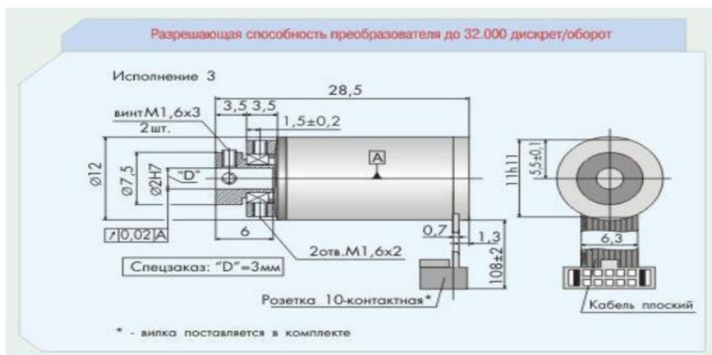
25 Сурет- ЛИР 212-А схемасы
