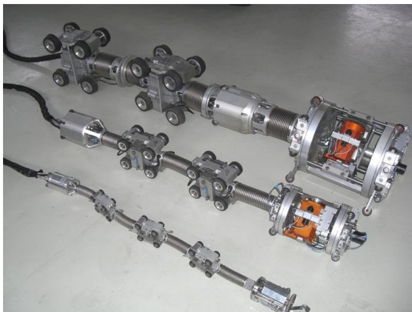
4 Сурет- Түрлі диаметрлі құбырларға арналған ВТД InspectorSystems роботы
